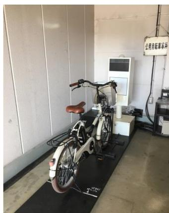
無線電動システムによる電動自転車
