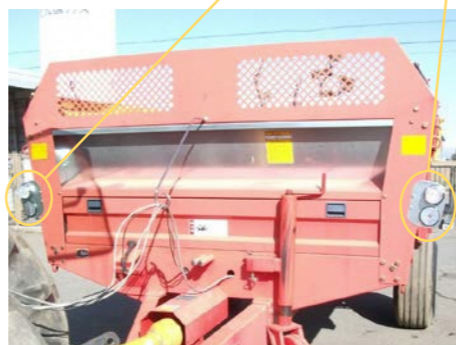
後部反射器及び灯火器類の設置例
