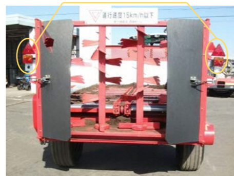
後部反射器及び灯火器類の設置例
