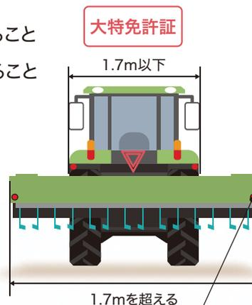
前面の両側に白色反射器、後面の両側に赤色反射器を備えること
