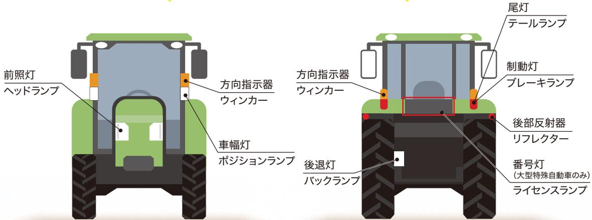
灯火装置、反射器の位置はトラクタのメーカー、シリーズ、型式により異なります。
