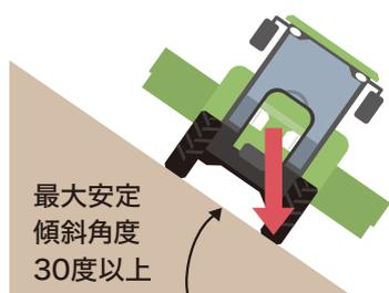
※車両総重量が車両重量の1.2倍以上又は、積載により重心高さが上がるものは最大安定傾斜角度35度以上
