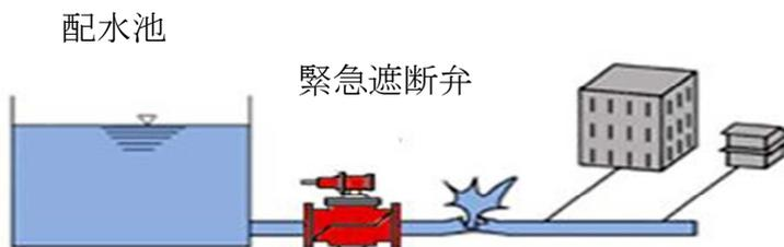
図 6-4 緊急遮断弁の設置概念図（配水池場内の配管に設置します。）
