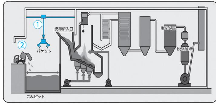
30ㄹの広さのごみを貯めるピットの縦幅を渡すように21ㄹのレールを設置しました。そのレールの上をバケットをクレーンで吊り下げた台車が走行し、ピットに貯まったごみをバケットでつかみ、焼却炉入口に投入します。
